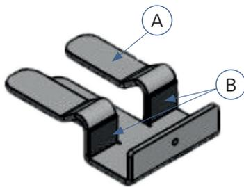
Pegar las almohadillas de espuma [B] en la parte inferior de la abrazadera soni Fix Clamp [A].
