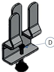
Colocar la pieza de presión [D] sobre la cabeza esférica del tornillo de presión [C] y presionar hasta que encastre.
